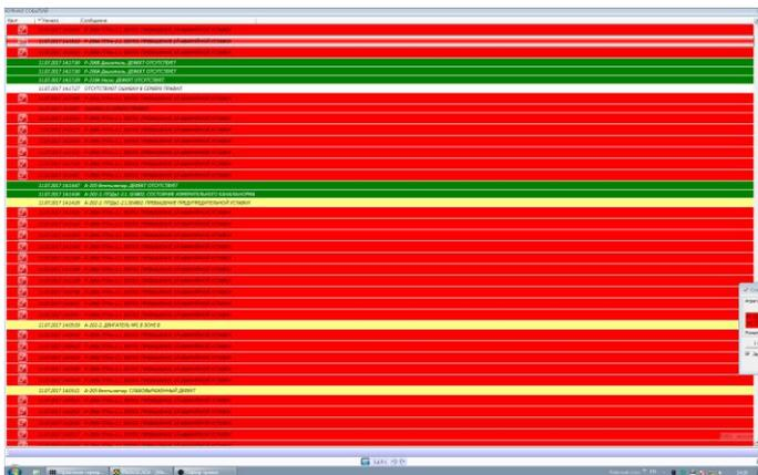
В журнале событий описываются все события, произошедшие с системой. Интерфейс оператора позволяет производить сортировку журнала по различным признакам в целях удобства поиска необходимого события.
