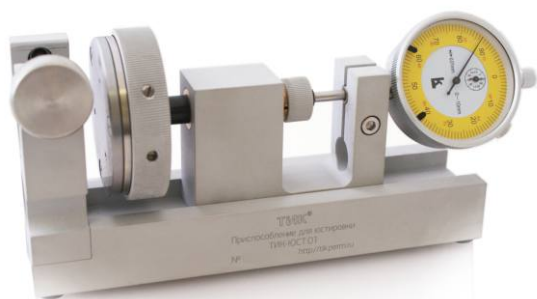
Приспособление для юстировки ТИК-ЮСТ (с диском из металла 40X)
